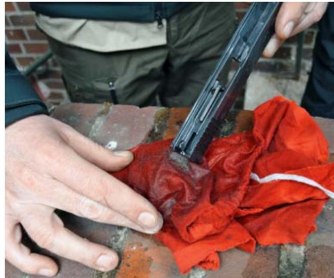
Selbst eine Glock Pistole benötigt hin und wieder eine gründliche Reinigung. Es ist erstaunlich, wie viel Pulverreste und Messingspäne sich im Schlagbolzenkanal ansammeln, wenn die Pistole über einen längeren Zeitraum intensiv benutzt wird.
