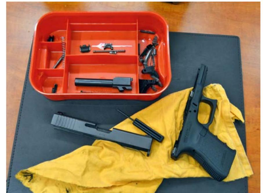
Die geniale Glock-Architektur gestattet eine einfache und schnelle Zerlegung bis ins kleinste Bauteil. Dazu wird lediglich ein Durchtreiber mit 2,5 mm Durchmesser benötigt.
