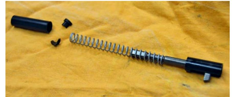
Kuriosum: Die Kunststoffhülse ganz links im Bild befindet sich im Schlagbolzenkanal des Verschlusses und ist auf keiner Glock-Explosionszeichnung zu finden.
