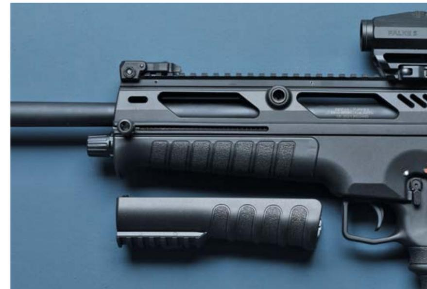
Blick auf die linke Waffenseite mit dem Ladehebel. Der Lieferumfang mit Wechselhandschutz mit kurzer Picatinny-Schiene an der Unterseite ist erfreulich umfangreich.
